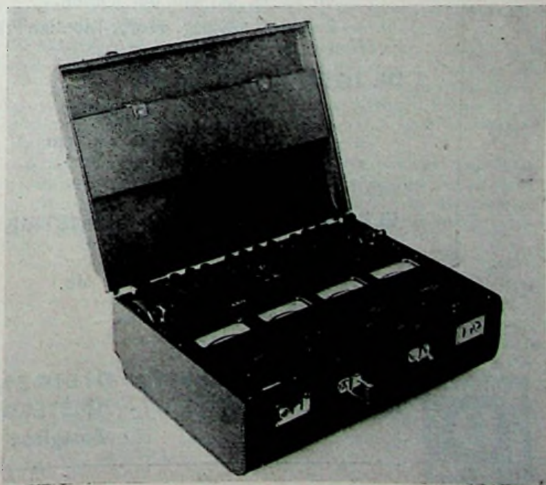
afb. 4. AEG meetkoffer met ingebouwde instrumenten. Bovenaan in het midden de draaiveldrichtingaanwijzer en aan de buitenzijden de vakken met de multistroomtransformatoren. Onderaan de vier schakelaars voor het maken van de verbindingen.
